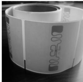
图3-3 沃尔玛使用的纸质电子标签
