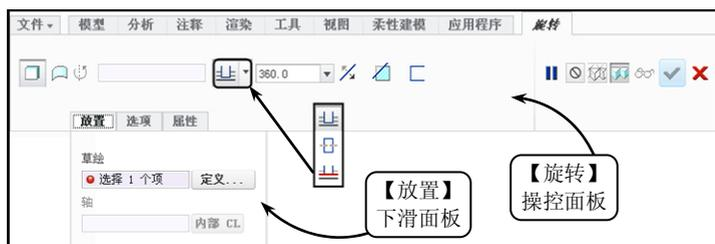
图 3-78 【旋转】操控面板
