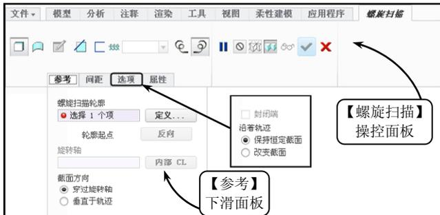
图 3-98 【螺旋扫描】操控面板
