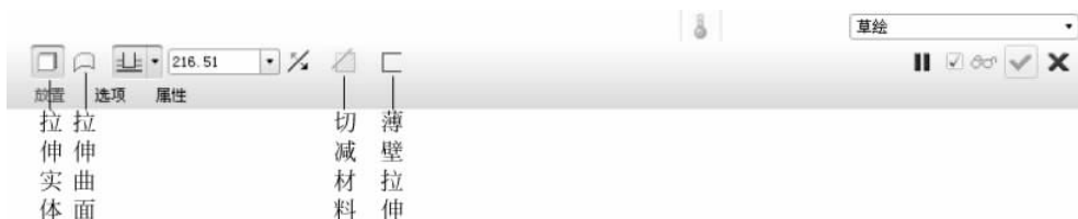
图 3-7 “拉伸”操作面板
