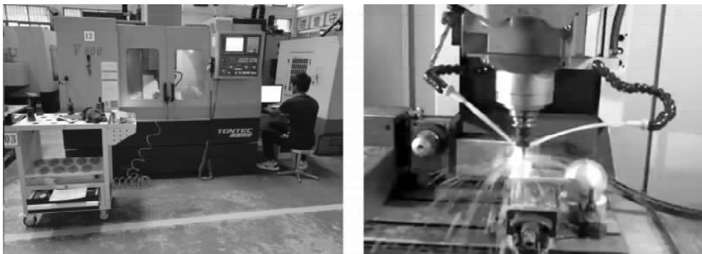
图 1-10 数控铣床工件切削工作场景
