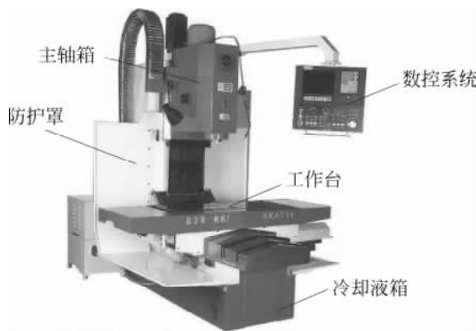
图 1-9 数控铣床的结构
