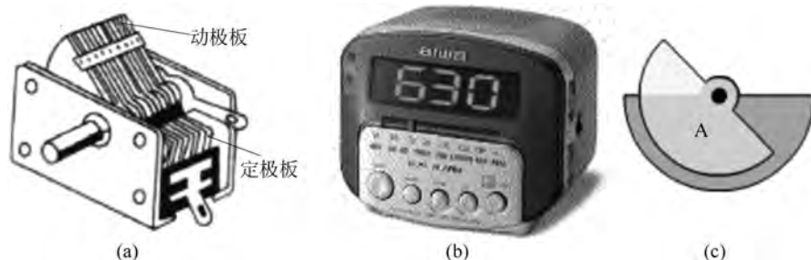
图 3-10 变面积型电容传感器的应用
