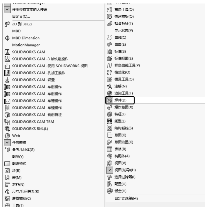
图 1-40 【自定义】工具栏选择【焊件】选项
