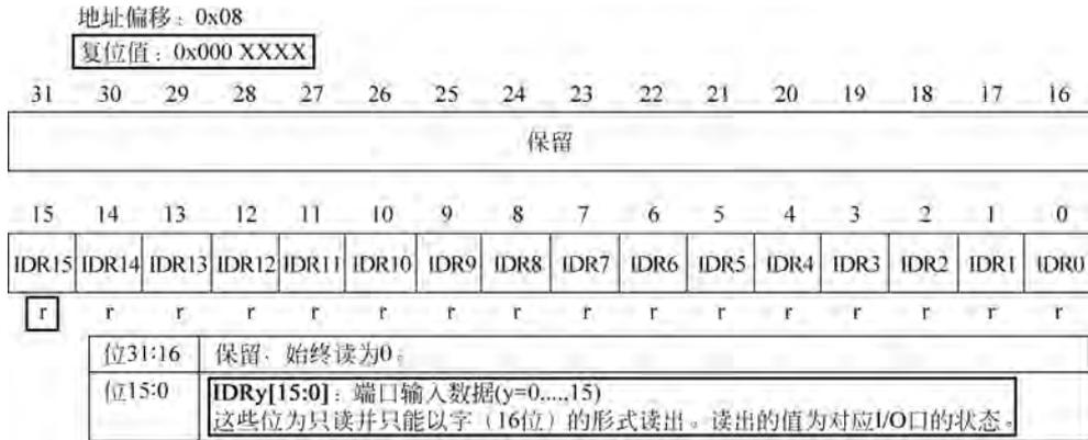
图 5-11 端口输入数据寄存器(GPIOx\_IDR)(x=A,...,G)
