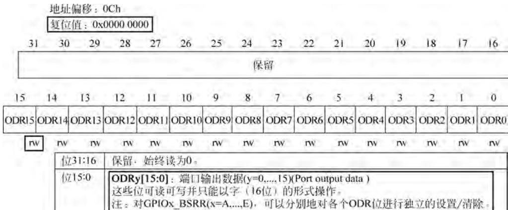
图 5-12 端口输出数据寄存器(GPIOx\_ODR)(x=A,...,G)
