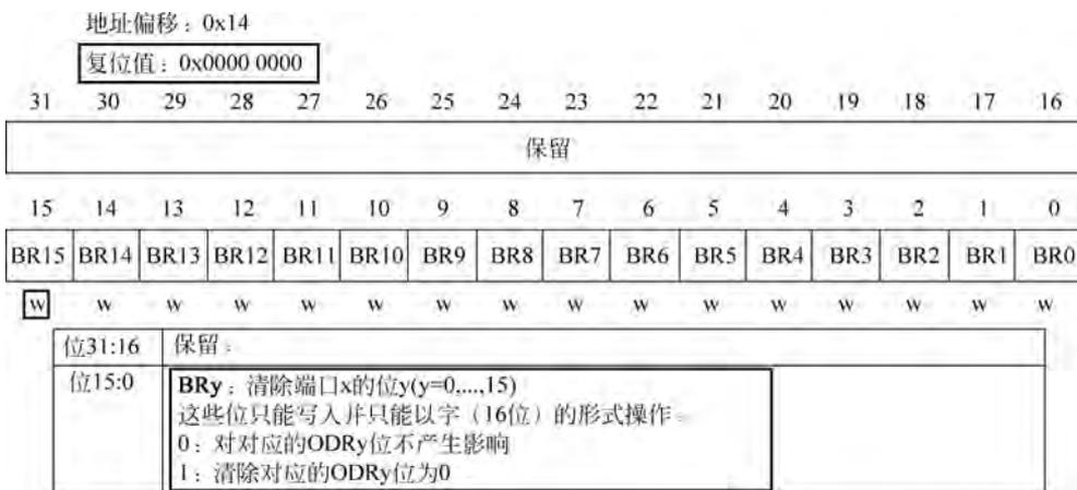
图 5-15 端口位清除数据寄存器(GPIO<sub>x</sub>\_BRR)( $x=A, \dots, G$ )
