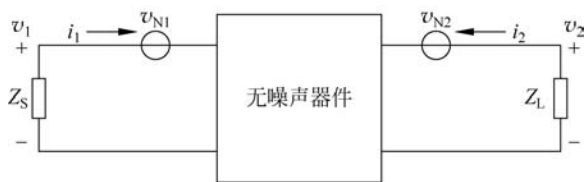
图 5.41 双端噪声电压源模型
