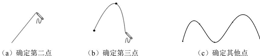
图 2-38 绘制样条曲线的过程
