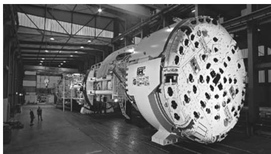
图 1.6.1 哥达基线隧道挖掘机
