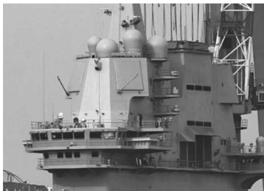
图 2.11.1 中国首艘国产航母的相控阵雷达
