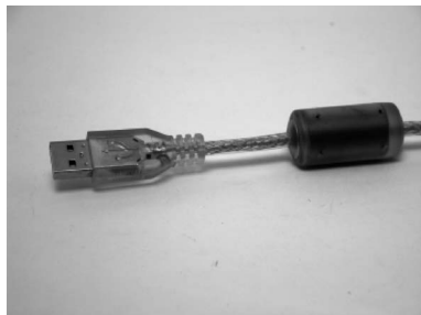
图 5-32 铁氧体芯用于 USB 电缆抑制辐射发射
