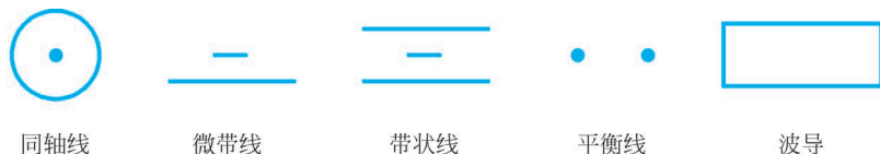
图 5-17 常用传输线的几何形状
