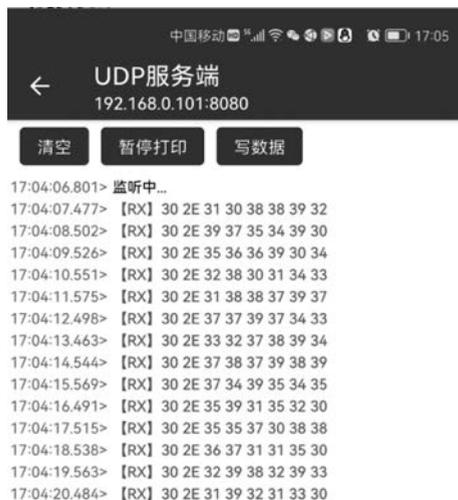
图 5-45 手机端网络调试助手接收到的 16 进制 UDP 数据包
