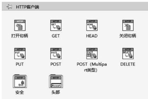
图 5-34 HTTP 通信相关函数节点
