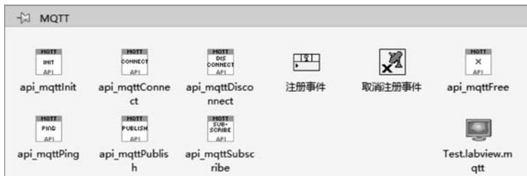
图 5-69 MQTT 工具包提供的函数节点
