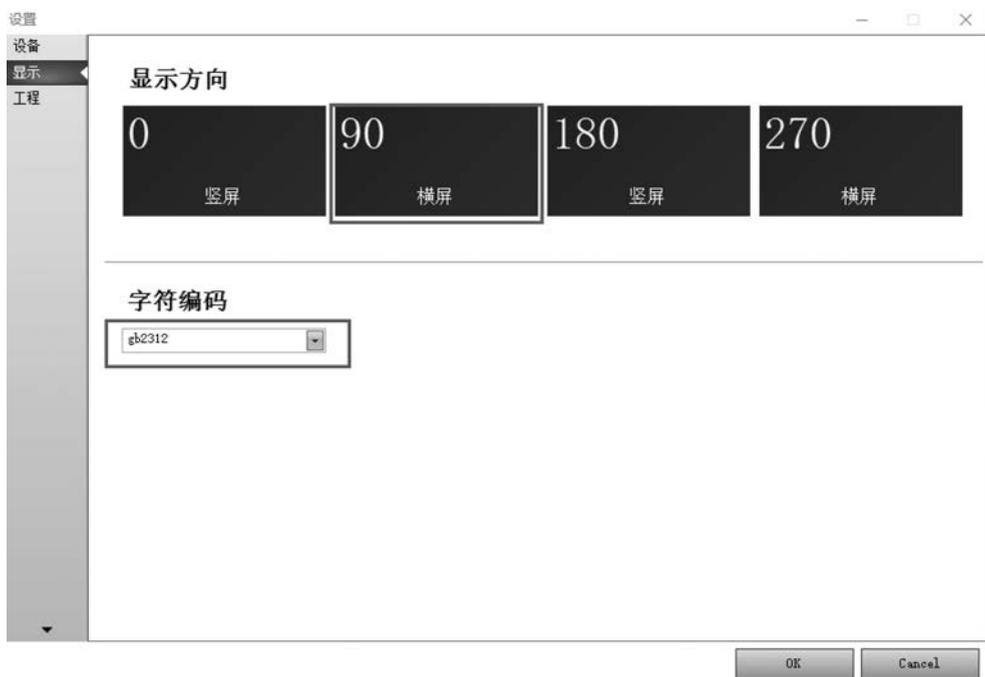
图 5-13 设置显示方向及字符编码方式
