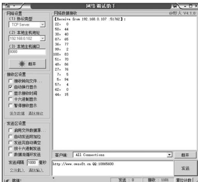
图 5-38 网络调试助手作为 TCP 服务器接收的数据
