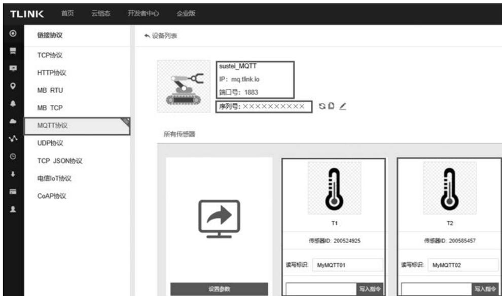
图 5-70 云端 MQTT 设备通信连接相关信息
