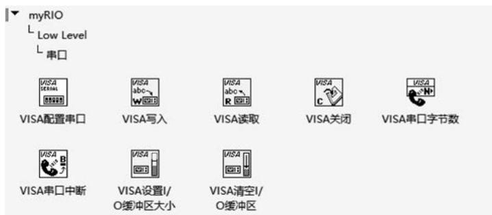
图 5-4 底层函数子选板中的 UART 通信相关 VI
