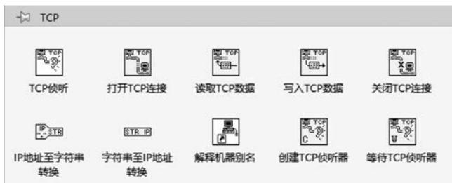
图 5-32 TCP 通信相关函数节点
