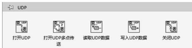
图 5-33 UDP 通信相关函数节点
