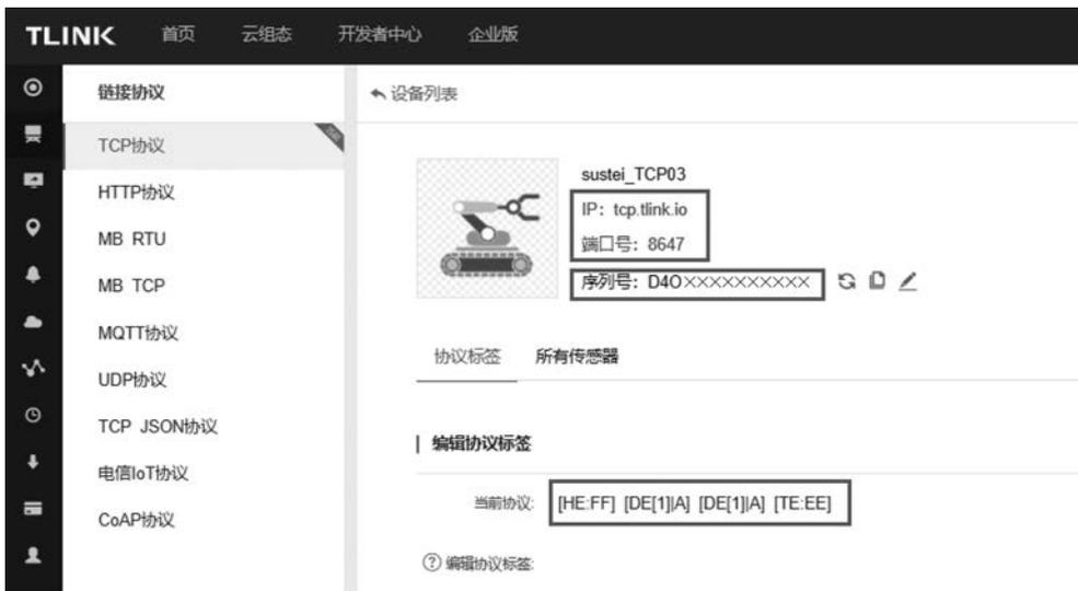
图 5-49 定义云端 TCP 设备用户数据协议
