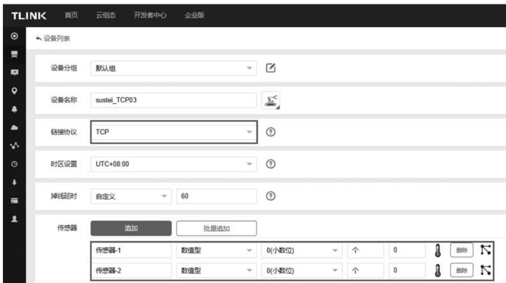
图 5-48 创建云端 TCP 设备
