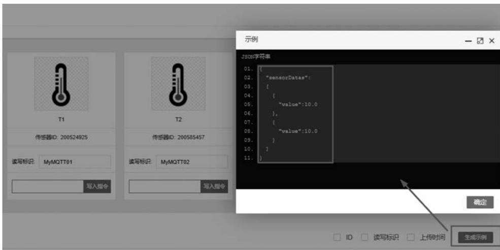
图 5-71 上报物联网平台云端 MQTT 设备的数据报文组成结构样例
