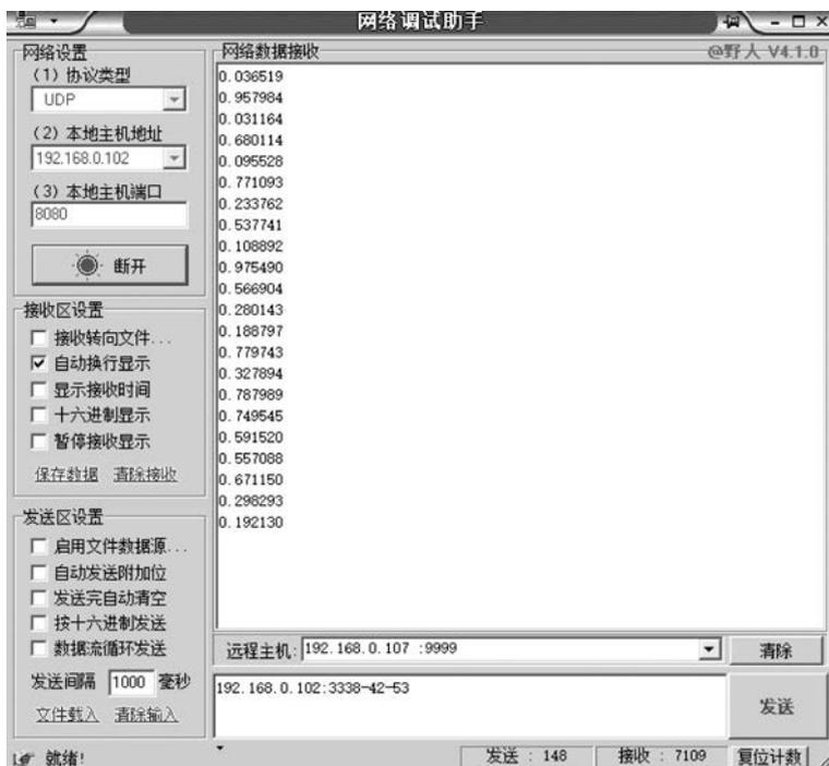
图 5-44 计算机端网络调试助手接收 myRIO 发送 UDP 数据包
