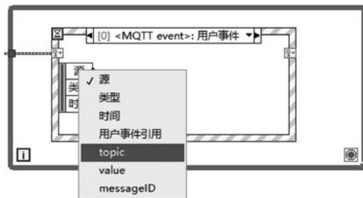
图 5-77 动态事件处理程序子框图左侧的事件数据节点
