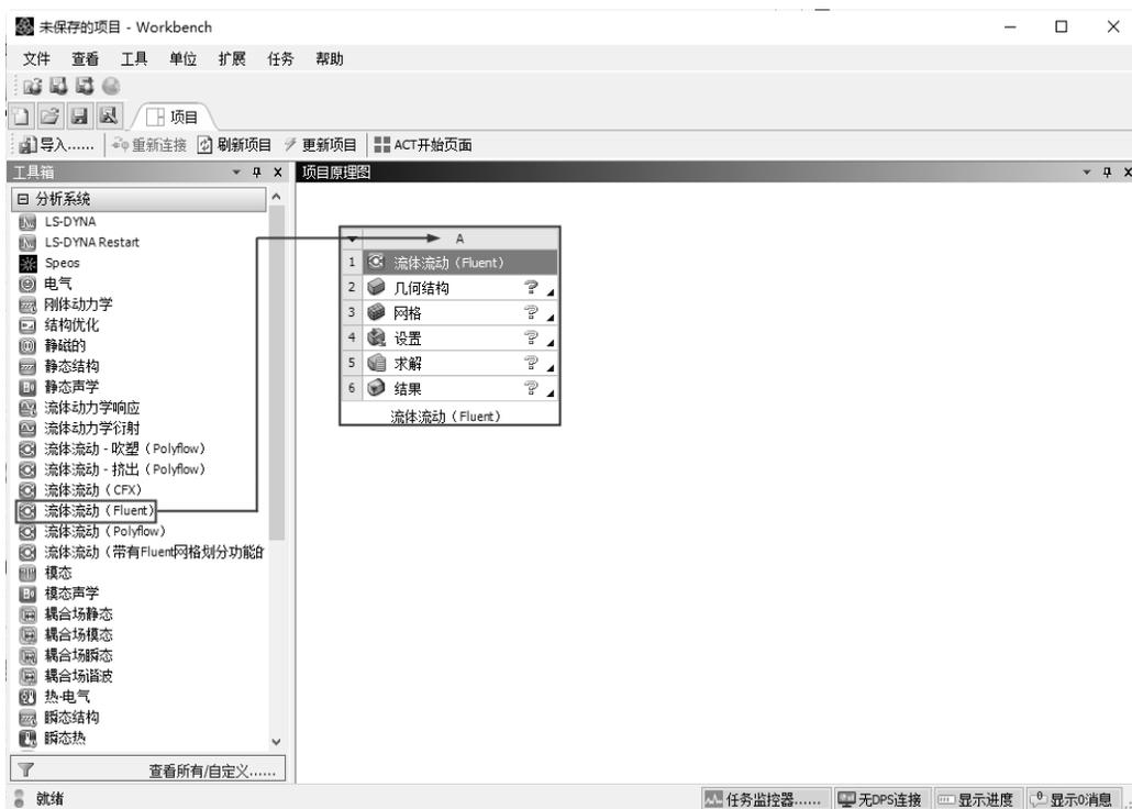
图 2-6 创建“流体流动 (Fluent)”项目
