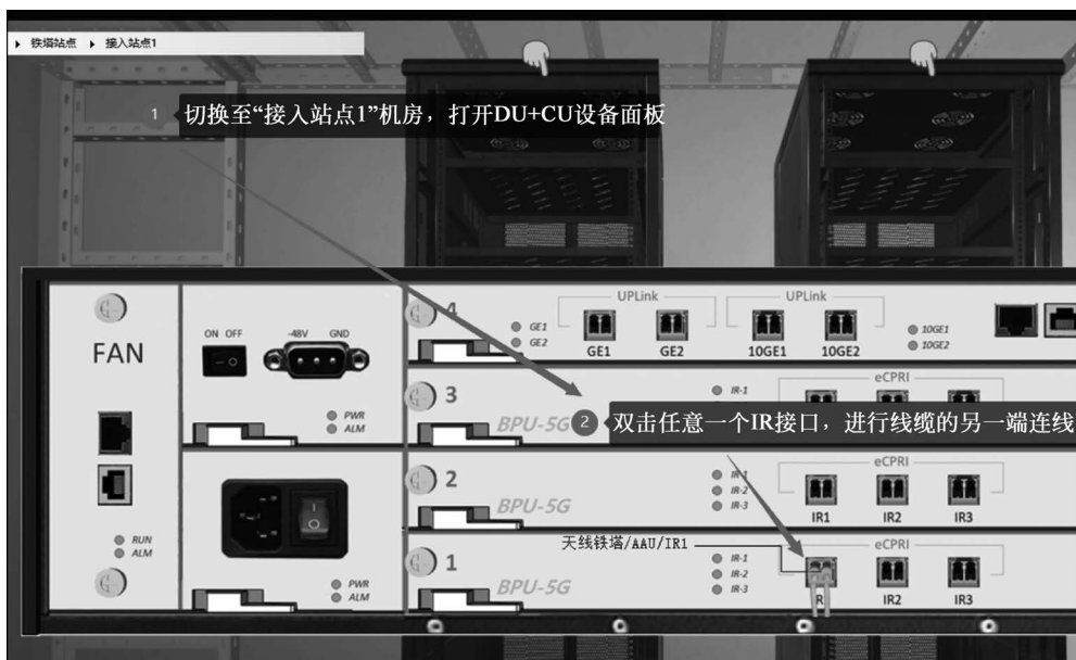
图 3-30 切换至机房,连接 IR 接口的另一端线缆
