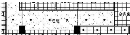
图 7-95 布置走道吊顶灯
