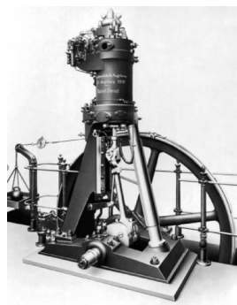
图 2-2 狄塞尔发明的压燃式发动机
