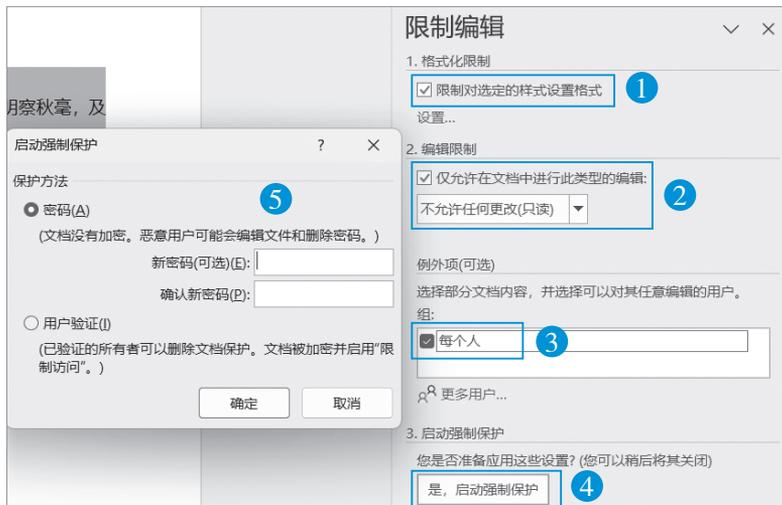
图1-37 限制编辑设置过程
