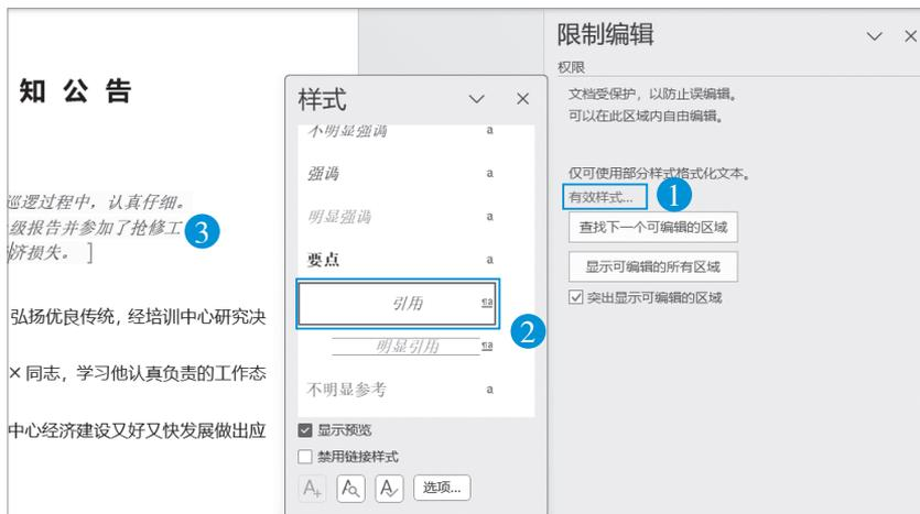
图1-39 允许段落的样式的选择
