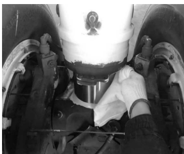
图 1-2-6 减震支柱镜面清洁
