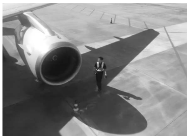
图 1-2-7 航空器绕机检查 1
