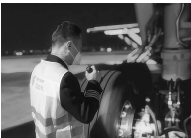
图 1-2-8 航空器绕机检查 2
