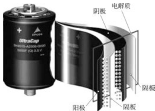
图 2-11 超级电容器结构示意图
