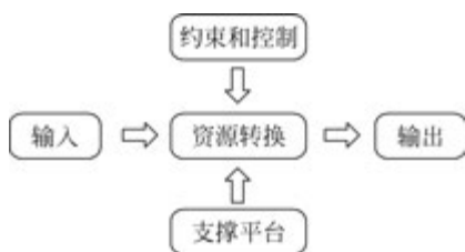
图 1-1 制造系统资源转换模型
