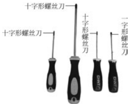
图 1-8 螺丝刀的外形图
