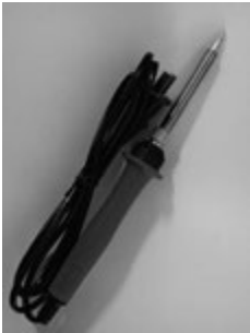
图 1-13 钢电烙铁的外形图
