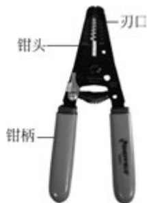
图 1-6 剥线钳的外形图
